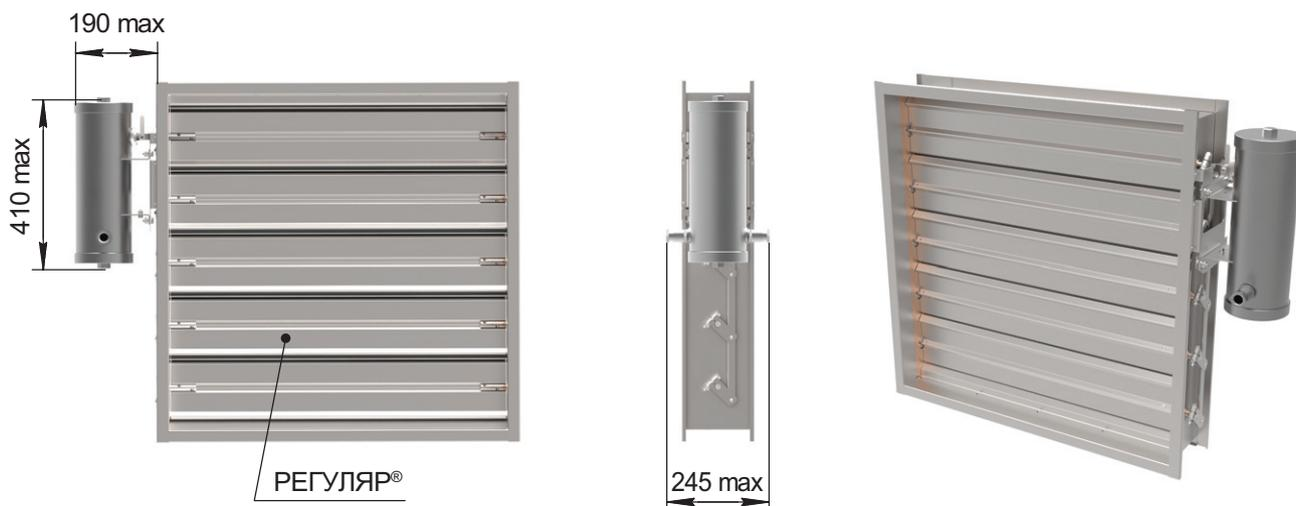
Электропривод взрывозащищенный ЕМАКС имеет меньшие габаритные размеры по сравнению с электроприводом ЭПВ. При установке ЭПВ на клапан расключение кабелей происходит внутри ЭПВ, при установке ЕМАКС расключение кабелей происходит в клеммной коробке, поставляемой в комплекте с электроприводом, длина кабелей мотора BELIMO (1м) позволяет установить коробку в любом доступном месте.
