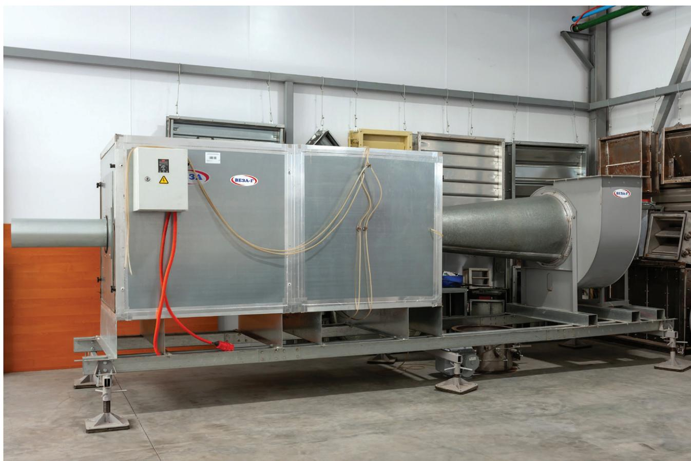
*Стенд для определения аэродинамического сопротивления оборудования*
