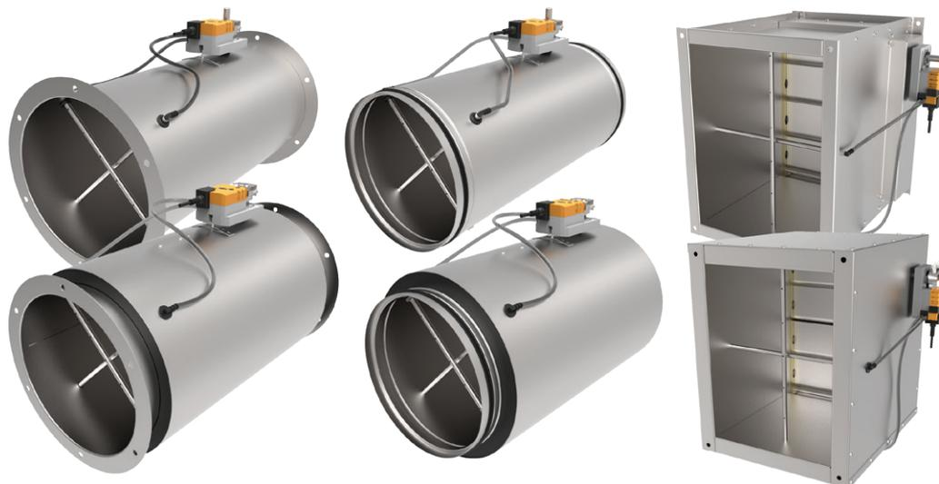
Регуляторы переменного расхода PEF-CMART для VAV систем (от английского названия «Variable Air Volume» - переменный расход воздуха) предназначены для работы в системах вентиляции со скоростью воздушного потока от 2 до 12 м/с и сохраняют работоспособность при любой их пространственной ориентации. Задачей регулятора является поддержание заданного количества приточного или вытяжного воздуха в зависимости от текущей потребности.
