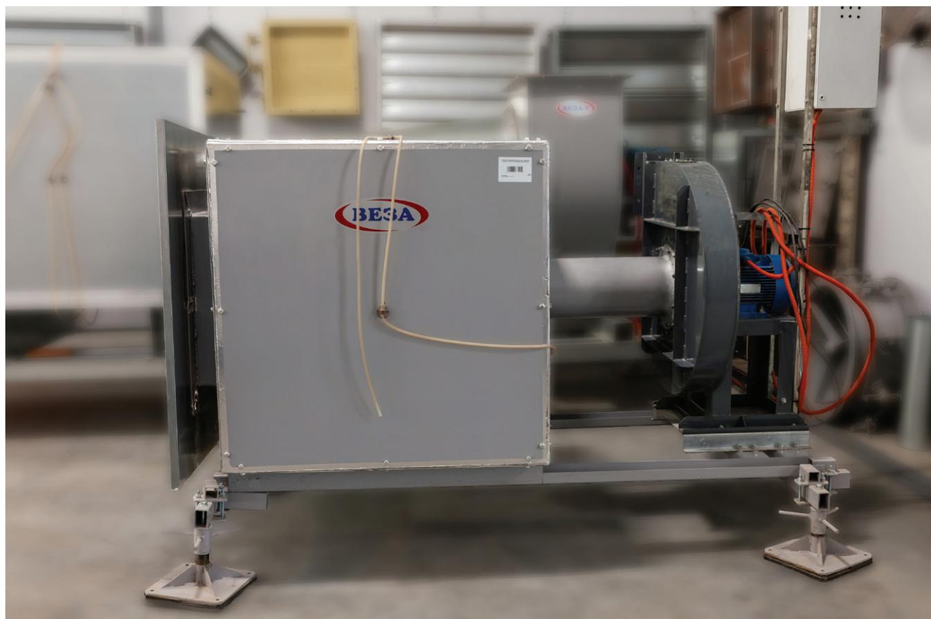
Стенд для определения предельного давления работоспособности клапана
