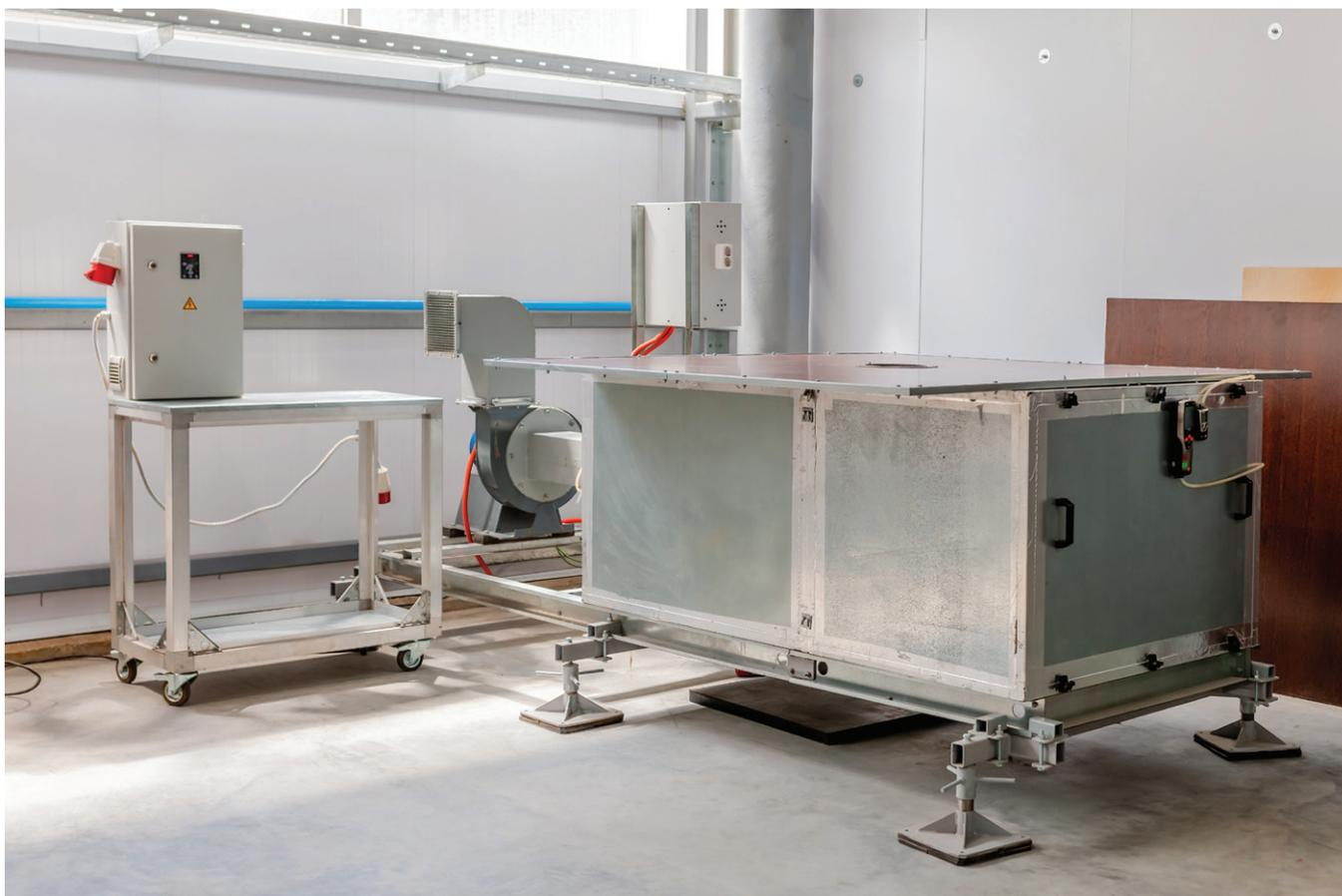
Стенд для определения объема протечек клапана
